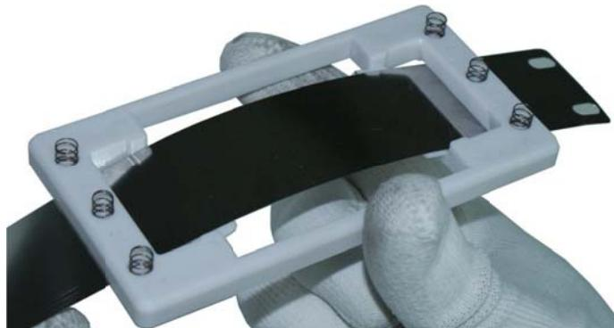
e)顛倒上續步驟從新安裝鋼帶與滑座蓋、因鋼帶需要調整、請先不要鎖緊固定鋼帶兩端的螺絲。
